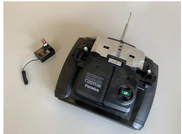
市售 3 通道 27MHz 板型遙控收發器
